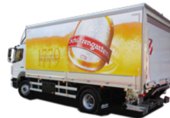
Code XL Brücke mit Hebebühne
